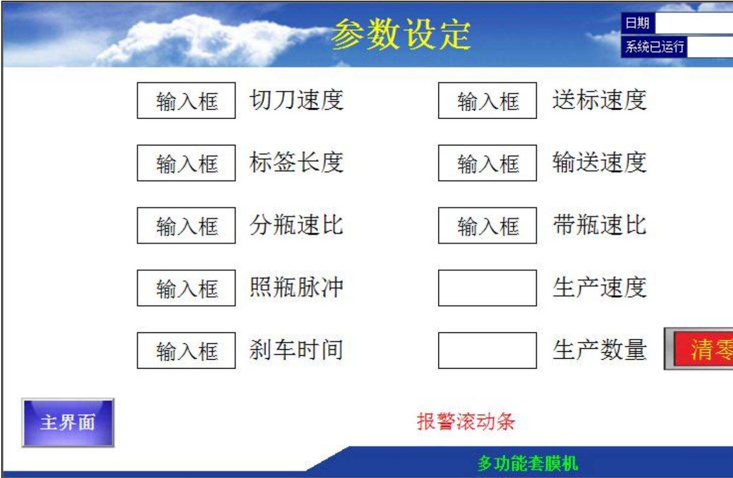
**切刀速度**: 套标机刀盘驱动电机的转速（1~9）
